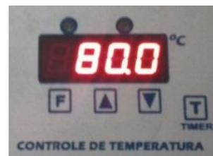
Mantenha tecla F pressionada para confirmar a informação, o visor voltará para temperatura ambiente, acionando o LED verde acima indicando aquecimento:
