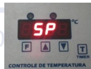
Pressionando F novamente entrará no parâmetro SP e com as teclas ▲ e ▼ seleccione a temperatura, que permanecerá piscando (ex: 80°C):
