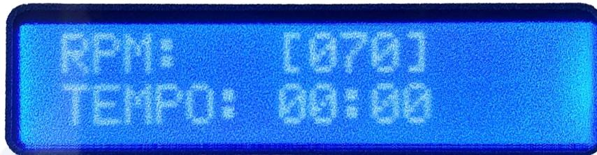
Pressione o botão
