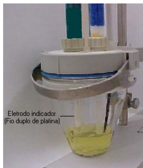
Figura 3. Esquema do vaso de titulador automático Karl Fischer volumétrico.
